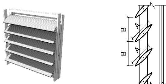
图 A. 3. 1-4 横白叶挡板外遮阳特征值的示意图
